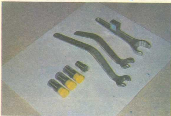
Рис. 3. Заменяемые элементы форсунок (слева), ключи для регулировки клапанного зазора (изогнутые) и ключ, фиксирующий верхнюю тарелку пружины.
